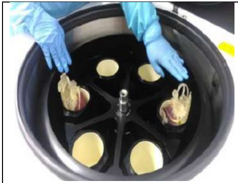
Gambar 2. Keseimbangan kantong dalam sentrifus
